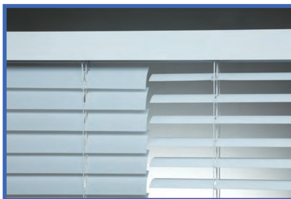
"2 in 1" - Zwei Jalousien in durchgehender Oberleiste. Die Lamellenpakete sitzen mit 5 mm Abstand. Bedienung 1x links und 1x rechts.
